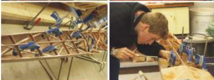
Da fast alle Holzverbindungen aus dem Leim gegangen waren, wurde alles mit modernem Polyurethankleber neu verleimt.
